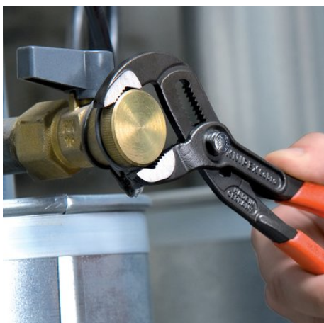
A forgásiránnyal szembe helyezett fogak önszorító hatást eredményeznek és megakadályozzák a megcsúszást a munkadarabon.
